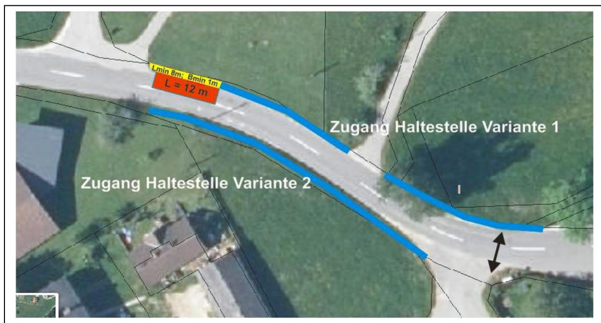
Abbildung 15: Schematische Darstellung der Randhaltestelle ohne Bucht (rot), Fahrgastwartfläche (gelb) und der Zugangsvarianten (blau) [Grundlage /11/, eigene Bearbeitung]
