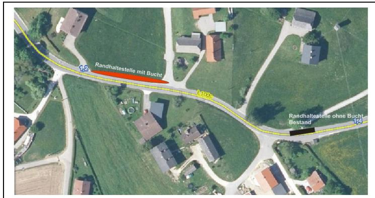
Abbildung 11: Schematische Festlegung der Randhaltestelle mit Bucht für eine Länge von 67m
