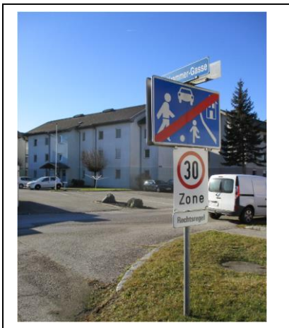
Foto 9 zu Z 1 in Abb.2: Obsolete Zonenbeschränkung, Falschinformationen durch die Zusatztafel Rechtsregel in Verbindung mit den Haifischzähnen
